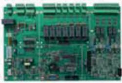
SmartLine036-4 EXT (un solo canal). Este panel de control de incendios es un panel convencional de la serie SmartLine y están equipados con un tablero de extinción de incendios SmartLoose. Todos los paneles de control de la serie SmartLoop soporta la tarjeta SmartLoop/PSTN que provee funciones de voz y marcador digital.
