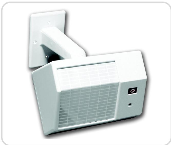
El DS794Z es un detector infrarrojo pasivo de largo alcance que utiliza el procesamiento de señal Motion Analyzer II, para una eficaz reducción de las falsas alarmas. Algunas características exclusivas -como el Motion Monitor-, le otorgan un alto grado de confiabilidad en la detección. La posibilidad de intercambiar las ópticas espejadas y la disponibilidad de tres diagramas de detección diferentes hacen que la instalación sea mucho más flexible y adaptable a cualquier aplicación.
