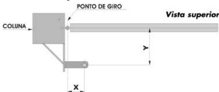
Suelde el soporte de fijación del accionador respetando las medidas (X), (Y) y (L) conforme la tabla abajo. Si el portón es de apertura interna, la medida (L) deberá ser determinada con la hoja cerrada. Si el portón es de apertura externa, la medida (L) deberá ser determinada con la hoja abierta.
